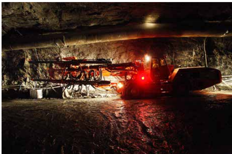
◀ Razicí stroj, který tvoří chodby budoucího úložiště (zdroj Posiva)
