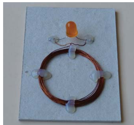
◀ Přijímač – podložka s cívkou a diodou LED
