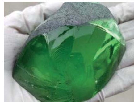
◀ Produkt vitrifikace firmy Kurion umožňuje bezpečné ukládání jaderných nebo nebezpečných odpadů
