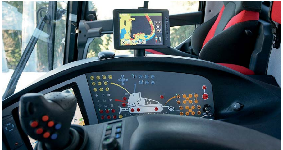
◀ Joystick místo volantu v kabině řidiče najdeme už u většiny sněžných fréz (foto Prinoth Co.)
