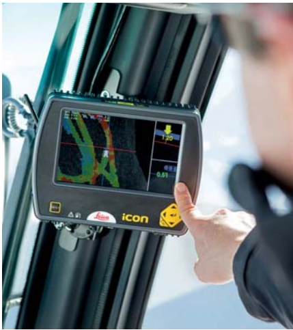
◀ Satelitní SNOWsat systém mapující pozici stroje v topografické mapě s přesností jednoho metru (foto Prinoth Co.)
