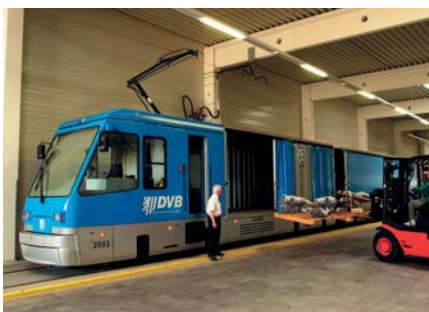
◀ Nakládání kontejneru se součástkami pro VW vidlicovým vozíkem do CarGo-Tram (foto J. Tůma)
